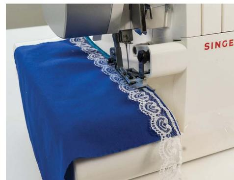
*Nota: Si la tela no necesita recortarse, ponga la tela y el encaje en la parte superior de la guía. Suelte la hoja. Ajuste la guía según requiera y cosa.*
