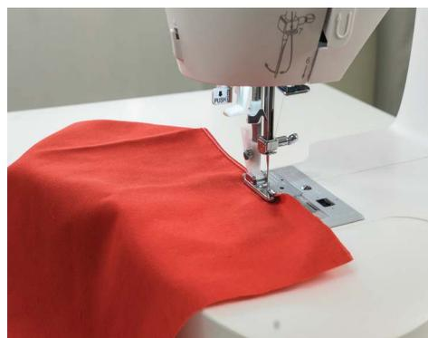
*Nota: El prensatelas para dobladillos enrollados también puede utilizarse para hilos para acolchado o hilos decorativos. Pase el extremo del hilo a través del embudo y en la ranura debajo del prensatelas. Configure la máquina para un zigzag o puntada decorativa, ajustando la longitud y el ancho como desee.*
