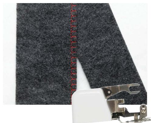
*Nota: La tensión de la máquina y el largo y ancho de la puntada pueden necesitar ajustarse dependiendo de la tela.*
