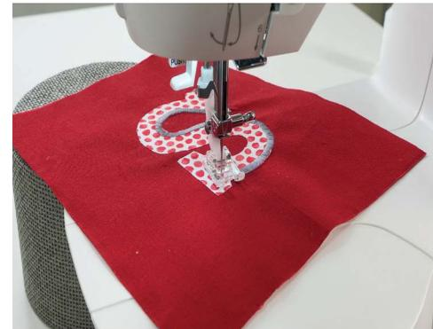
*Nota:* Se pueden usar hilos metálicos, de tweed u otros hilos decorativos en la parte superior de la máquina. Mantenga el hilo multiusos en la canilla.
