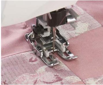
1. Para desmontar el soporte del prensatelas, desenrosque su tornillo.
